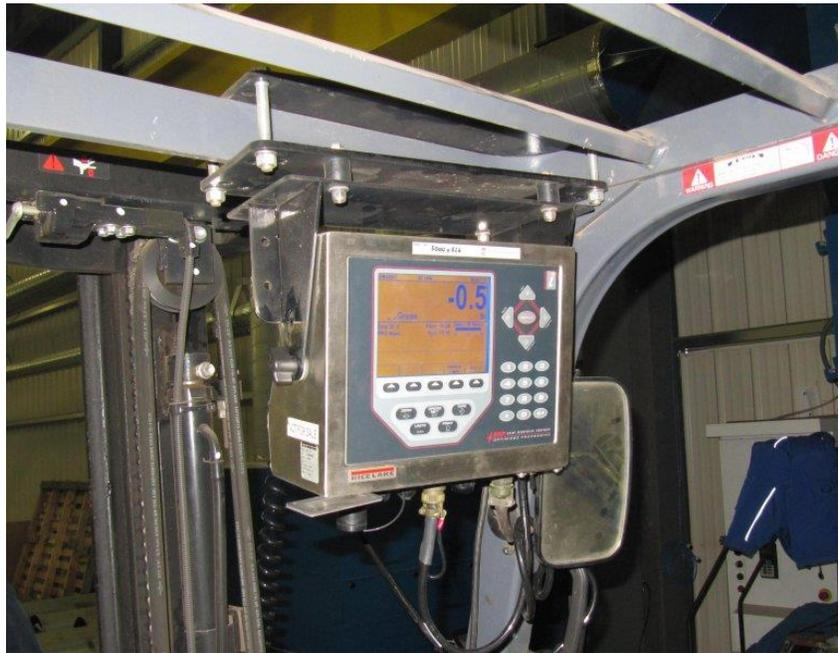
**Typical CLS-920i installation / Installation typique du modèle CLS-920i**
