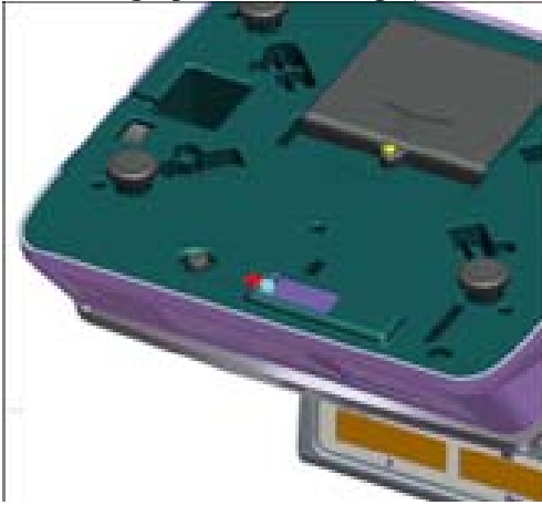
Typical location of seal for model PC-2400 / Emplacement typique du scellé du modèle PC-2400
