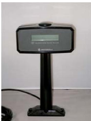
Typical model MX201 remote display / Dispositif d'affichage à distance modèle MX201 typique
