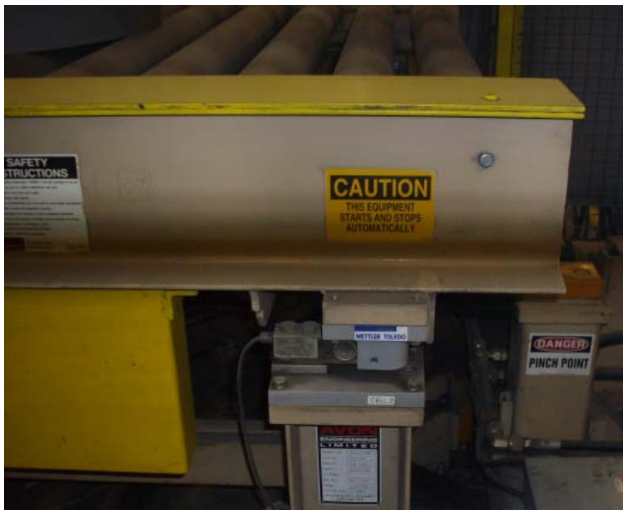
Typical load cell mounting for model ISI SK6070 / Montage typique de la cellule de pesage du modèle ISI SK6070
