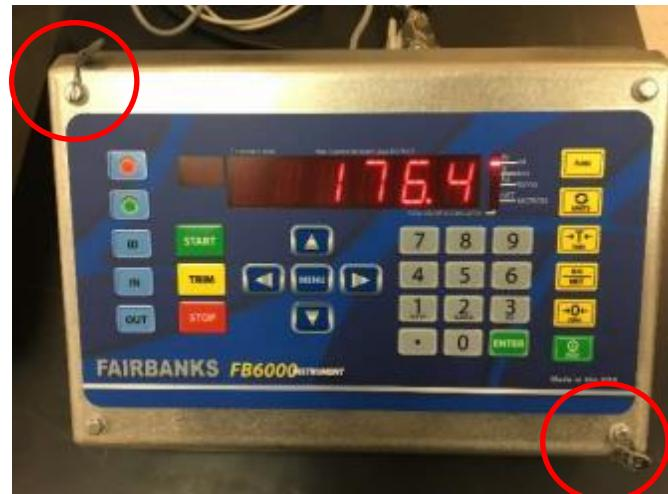
Typical models FB60x5-zzz, with sealing on the upper left and lower right / Modèles FB60x5-zzz typiques, avec scellage en haut à la gauche et en bas à la droite
