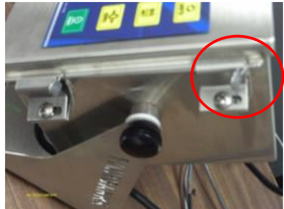
Typical sealing for models FB6002-zzz and FB6012-zzz / Scellage typique pour modèles FB6002-zzz et FB6012-zzz typiques
