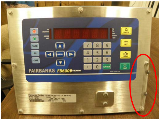
Typical models FB6003-zzz and FB6013-zzz, with sealing on the right / Modèles FB6003-zzz et FB6013-zzz typiques, avec scellage à la droite
