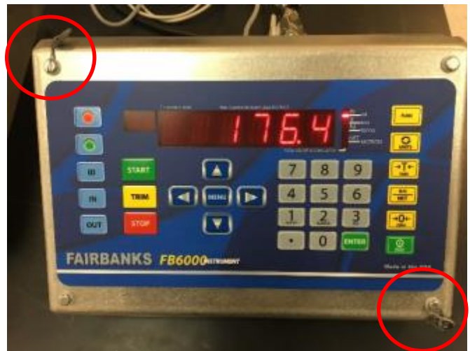
Typical models FB6005-zzz and FB6015-zzz, with sealing on the upper left and lower right / Modèles FB6005-zzz et FB6015-zzz typiques, avec scellage en haut à la gauche et en bas à la droite
