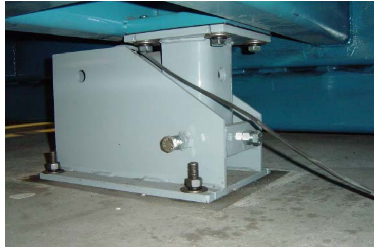
Typical feet and load cell mounting of model EDC-20-72 / Pied et montage de la cellule de pesage typiques du modèle EDC-20-72
