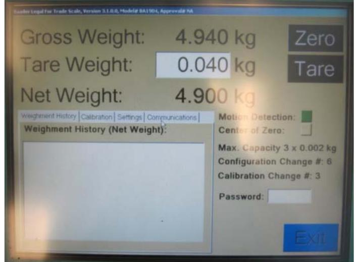
**Typical operator display of model BA-1902-30 / Affichage typique de l'opérateur du modèle BA-1902-30**
