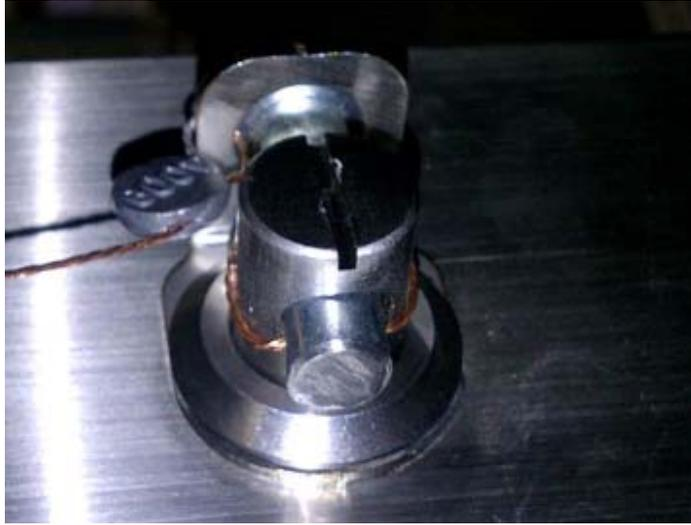
**Typical seal on model LDU / Scellé typique du modèle LDU****SECTION 9 - Evaluated by**
