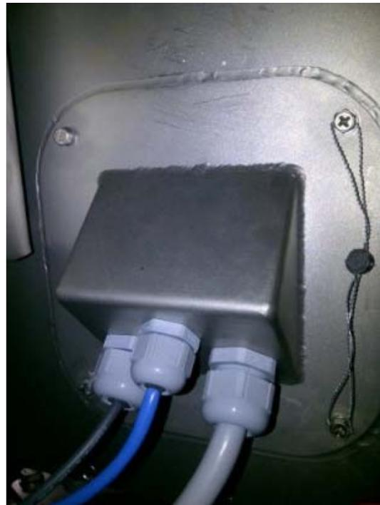
**Typical seal behind model BA-1902-D / Scellé typique situé derrière le modèle BA-1902-D**
