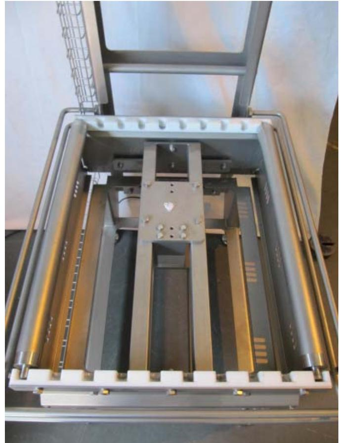
**Sub platter and load cell mounting / Sous plateau et montage du cellule de pesage**
