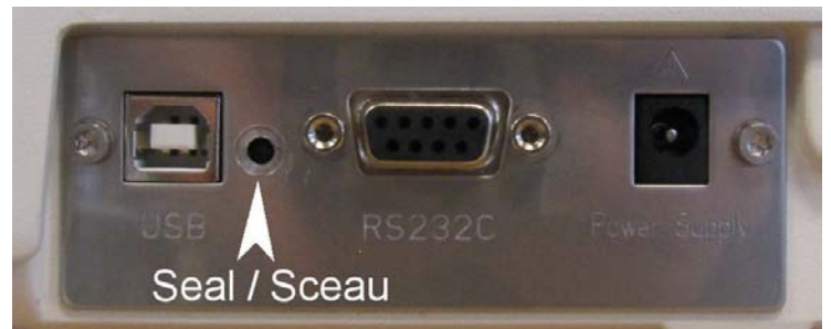
Paper seal location for models MS***S/A** and MS***SDR/A** / Emplacement du sceau de papier des modèles MS***S/A** et MS***SDR/A**
