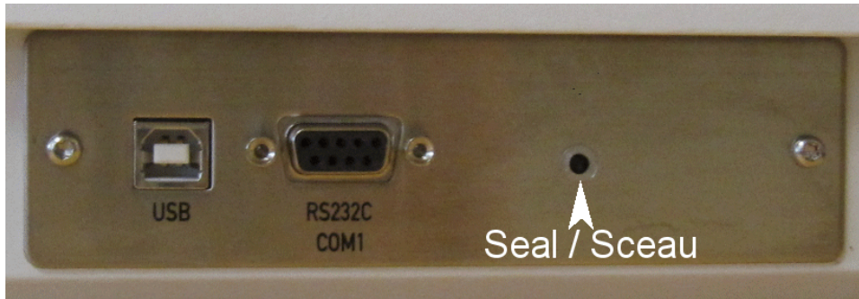
Paper seal location for models MS***KLE/A**, MS***KLIPE/A**, MS***L/A** and MS***LDR/A** / Emplacement du sceau de papier des modèles MS***KLE/A**, MS***KLIPE/A**, MS***L/A** et MS***LDR/A**
