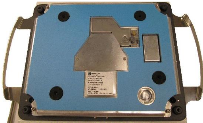
Typical sub-frame and sealing / Sous-chassis et scellé typiques
