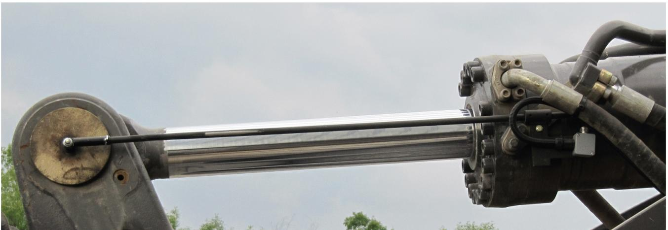
Typical bucket position switch / Capteur de position du godet typique
