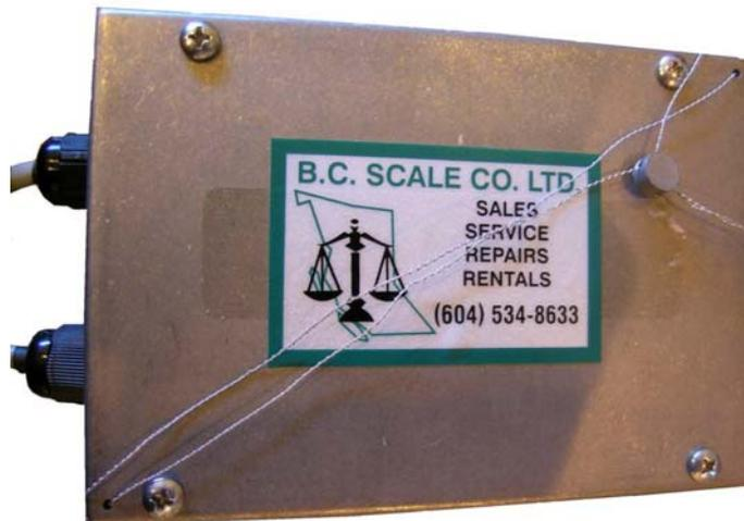
**Typical junction box and sealing / Boîte de jonction et scellage typique**
