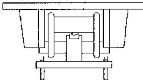
Load cell mounting / Montage de la cellule de pesage
