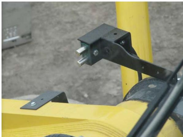
**Typical weighing zone sensor / Interruuteur de zone de pesage typique.**
