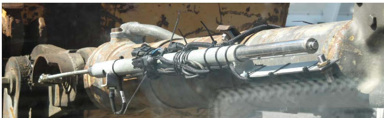
Typical bucket position switches / Interrupteurs typiques de position de godet
