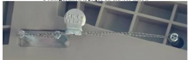
Typical underside sealing LE.3k / Scellage typique en dessous de l'appareil LE.3k
