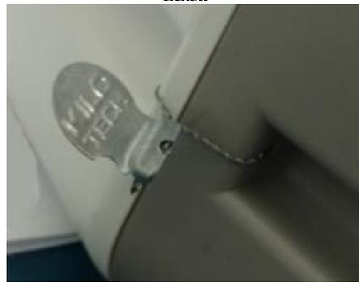
**Typical rear sealing LE.3k / Scellage typique à l'arrière de l'appareil LE.3k**
