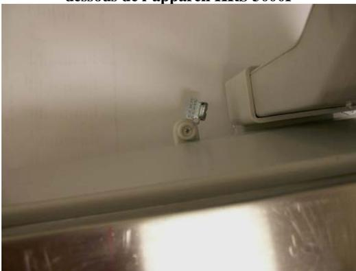
**Typical rear sealing KRS 3000P / Scellage typique à l'arrière de l'appareil KRS 3000P**
