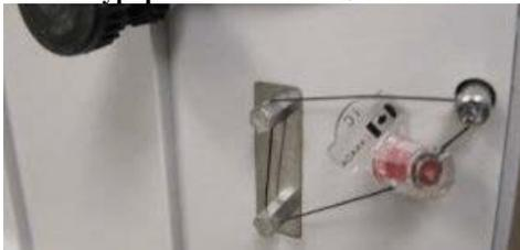
**Typical underside sealing KRS 3000P / Scellage typique en dessous de l'appareil KRS 3000P**
