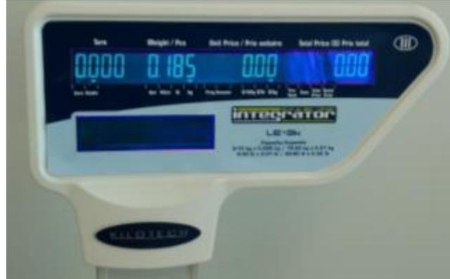
**Alternate operator & customer display LE.3k / Affichage destiné à l'opérateur et aux clients alterné LE.3k**
