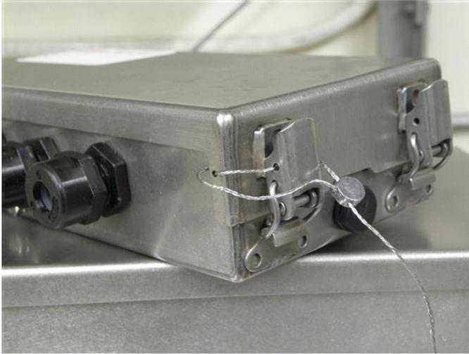
**Typical seal for sectional controller model ACC-2000-1A / Scellé typique du contrôleur sectionnel de modèle ACC-2000-1A**
