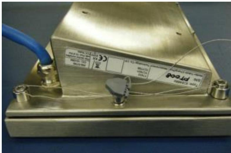
**Typical wire seal for model ICS426x or ICS466x / Scellé fil typique pour le modèle ICS426x ou ICS466x**
