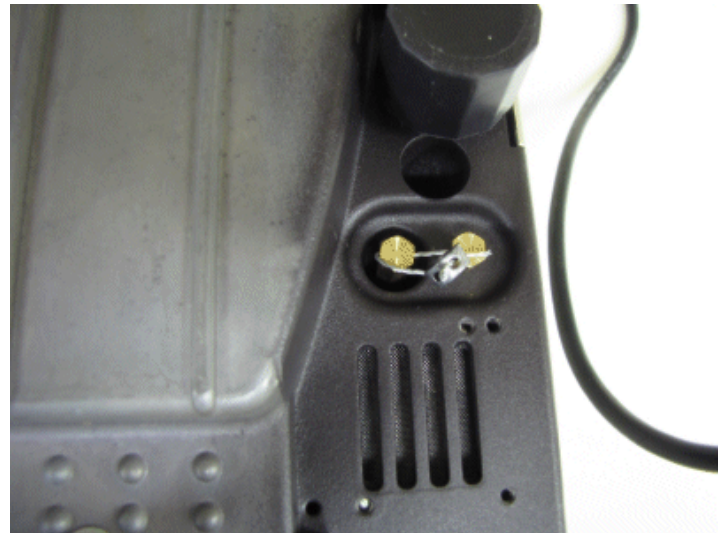
Typical housing seal for all approved models except for model SM-5000H Audit Trail / Scellé typique du boîtier pour tous les modèles approuvés à l'exception du modèle SM-5000H Audit Trail
