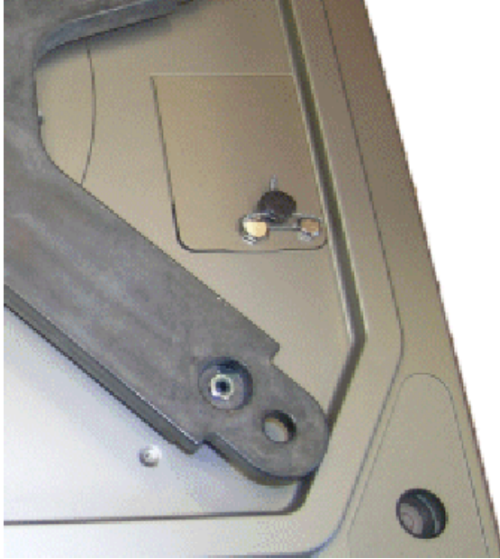
Typical calibration switch seal for all approved models except for model SM-5000H Audit Trail / Scellé typique de l'interrupteur d'étalonnage de tous les modèles à l'exception du modèle SM-5000H Audit Trail
