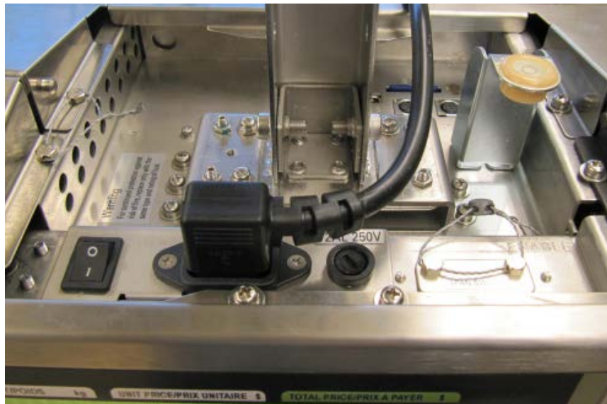
Typical housing and calibration switch seals of model SM-5000H Audit Trail / Scellés typiques du boîtier et de l'interrupteur d'étalonnage du modèle SM-5000H Audit Trail
