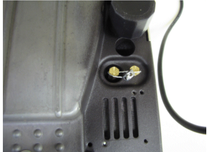
Typical housing seal for all approved models except for model SM-5000H / Scellé typique du boîtier pour tous les modèles approuvés à l'exception du modèle SM-5000H
