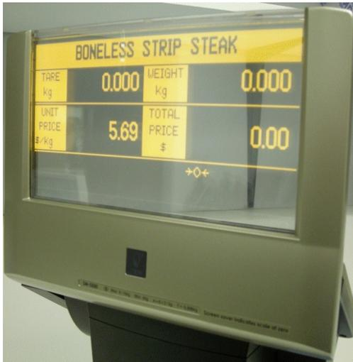
**Typical customers' display of models SM-5500P EL and SM-5500EV EL / Affichage destiné aux clients typique des modèles SM-5500P EL et SM-5500EV EL**
