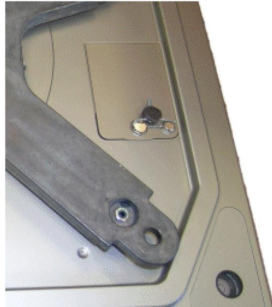
**Typical subplatter seal / Scellé dessous plateau
