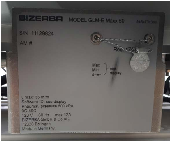
Typical sealing used to cover the calibration switch / Scellage typique utilisé pour couvrir le commutateur d'étalonnage
