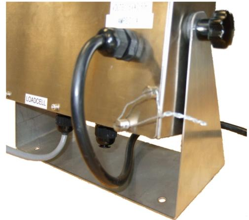
**Typical seal for ISI-799 or ISI-799DC model / Scellé typique pour le modèle ISI-799 ou ISI-799DC**
