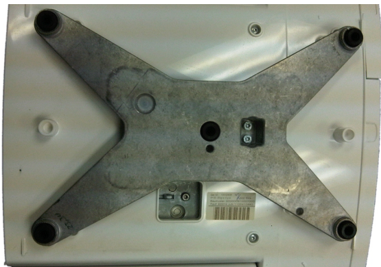
Typical subplatter and sealing for the KH 100-#, KH 200-# and KH 800-# models / Sous-plateau et scellage typique pour les modèles KH 100-#, KH-200-# et KH 800-#
