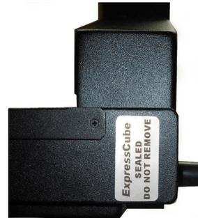
Sealing on side of rear sensor panel / Scellage sur le côté du panneau à capteurs arrière
