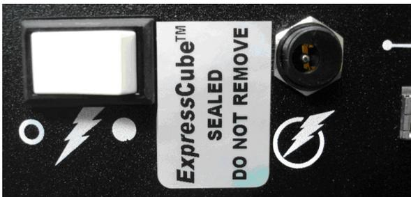
Rear plug sealing / Scellage du bouchon arrière
