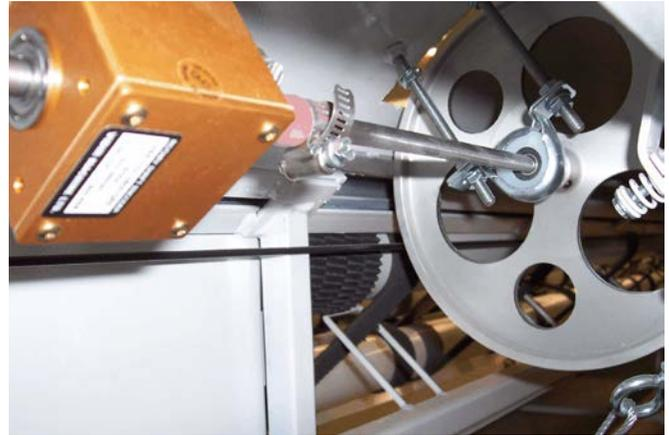
Encoder bolted to the main drive motor / Codeur boulonné au moteur d'entraînement principal
