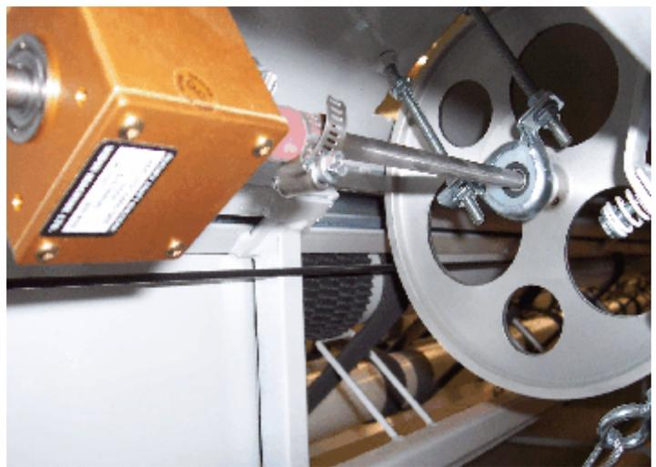
Encoder Bolted to the Main Drive Motor/Encodeur boulonné au moteur d'entraînement principal
