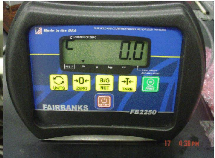
Typical FB2250-X indicator with ABS housing / Indicateur FB2250-X typique avec boîtier en ABS
