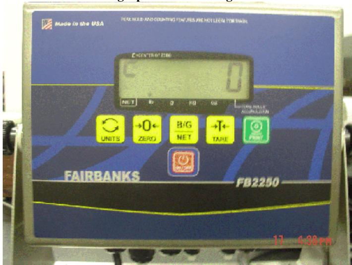
Typical FB2250-X indicator with stainless steel housing / Indicateur FB2250-X typique avec boîtier en acier inoxydable
