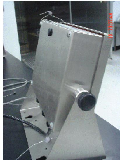
**Typical seal for model FB2250-K / Scellage typique pour modèle FB2250-K**
