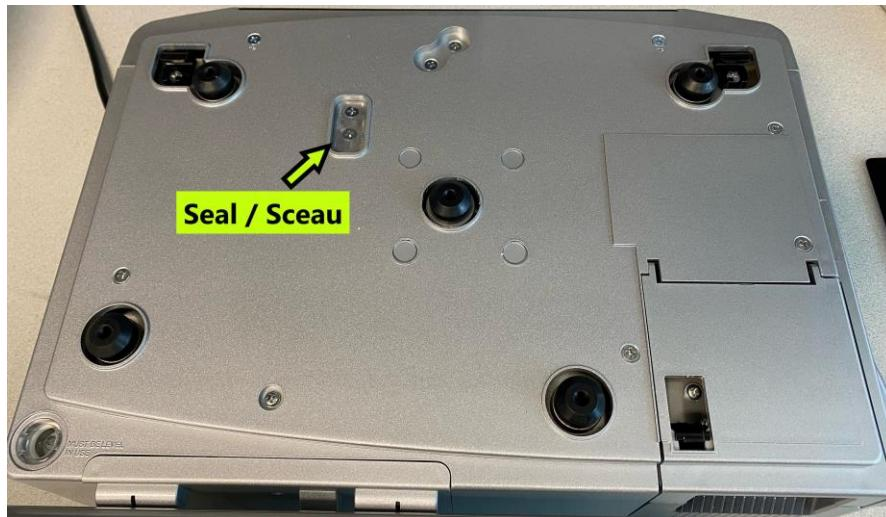
**Sealing method and sub-platter / Méthode de scellage et sous-plateau**
