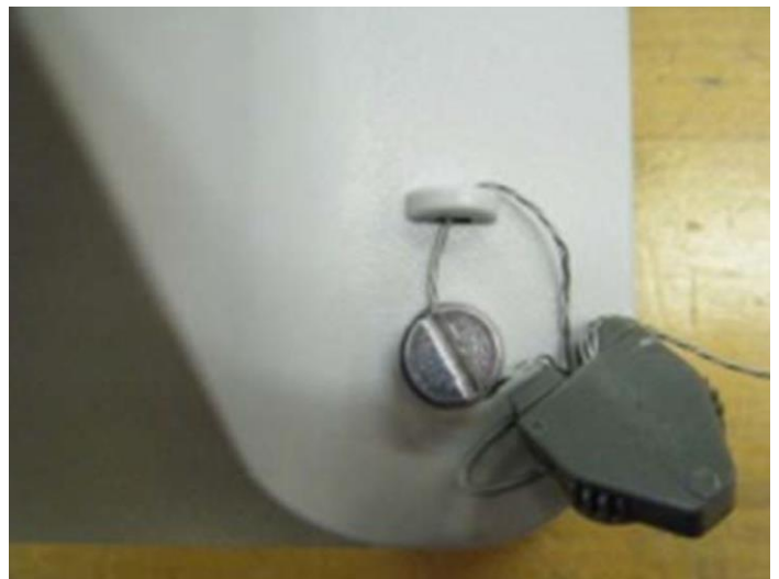
Typical sealing method for model BBA231-caannn / Méthode de scellage typique du modèle BBA231-caannn
