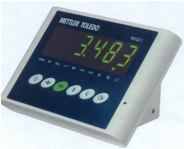
Typical model BBA221-caannn indicating element / Dispositif indicateur pondéral typique du modèle BBA221-caannn
