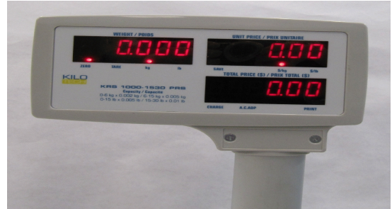
Typical operator's display for models KRS 1000-1530PRS / L'affichage typique destiné à l'opérateur du modèle KRS 1000-1530PRS
