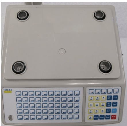
Typical sub-platter for model KRS 1000-1530PRS/ Sous-plateau typique du modèle KRS 1000-1530PRS
