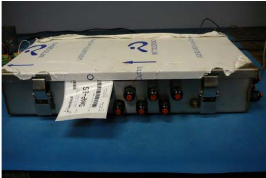
Typical junction box used to house SNAP-8S, SNAP-12S or SNAP-16S / Boîte de jonction typique pour les modèles SNAP-8S, SNAP-12S ou SNAP-16S
