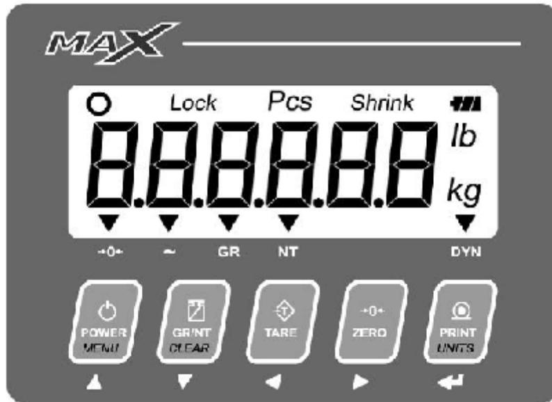
Typical MAX Display and Operator Controls / Affichage et touches destinées à l'opérateur typiques du modèle MAX
