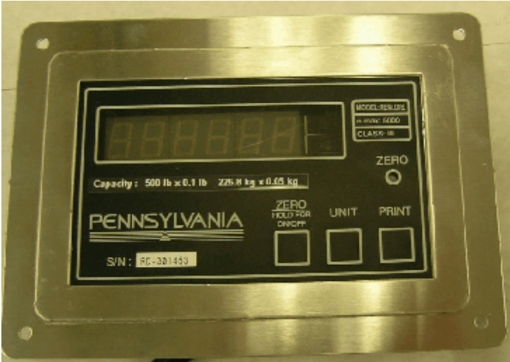
REM DIS Display with Operator Controls / Affichage REM DIS avec boutons de contrôle destinés à l'opérateur
