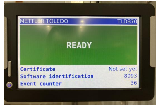
Typical display and ready condition for TLD870 (The event counter has not been evaluated by Measurement Canada and is not covered by this Notice of Approval.) / Affichage typique et état prêt pour le TLD870 (Le compteur d'événements n'a pas été évalué par Mesures Canada et n'est pas couvert par cet avis d'approbation.)
