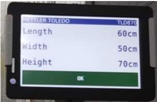
Typical display for TLD870 with all dimensions / Affichage typique pour le TLD870 avec toute les dimensions
