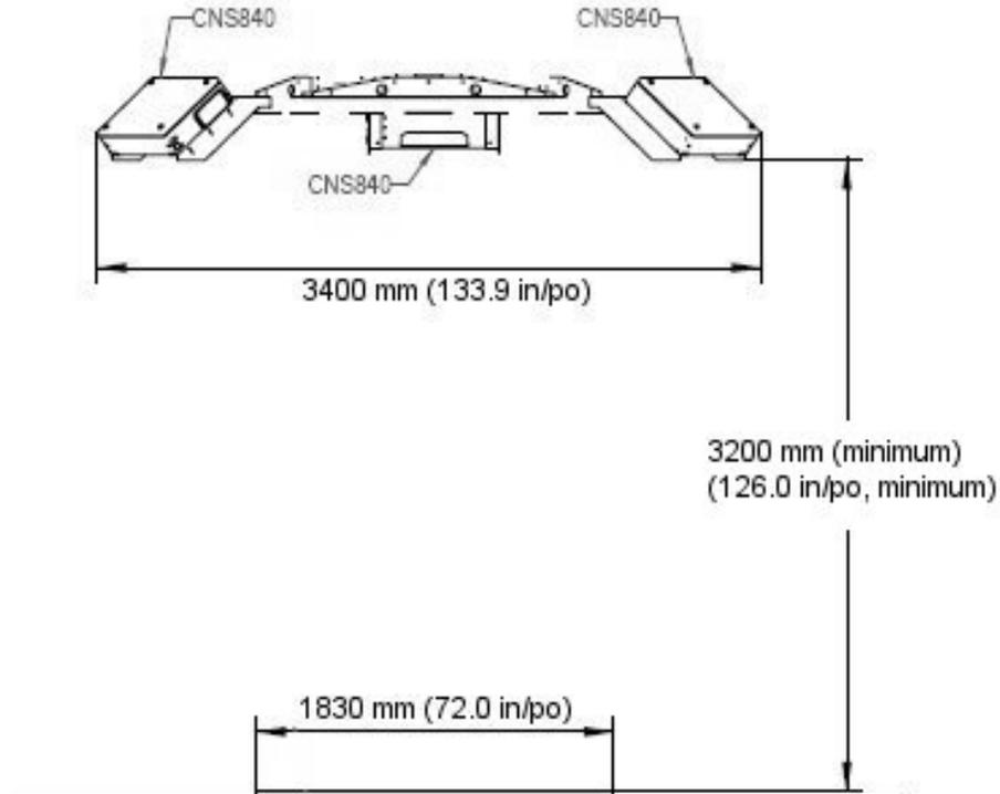
**Installation Dimensions / Dimensions de l'installation**
