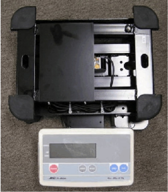
Typical Model FG series sub-platter / Sous-plateau typique de la série modèle FG
