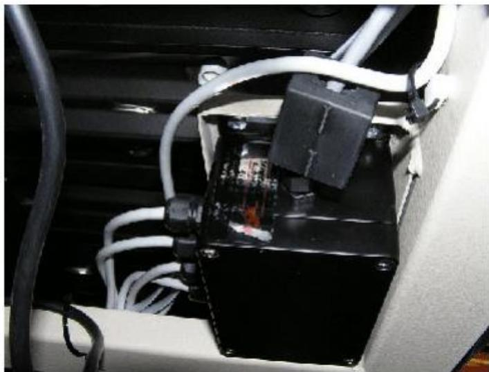
Sealing of Junction Box with Paper Seal for CubiScan 150-LFT / Scellage de la boîte de jonction avec scellé en papier pour CubiScan 150-LFT
