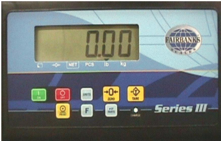
Typical Series III Display and Operator Controls/ Affichage et touches de contrôle typiques pour le modèle Series III
