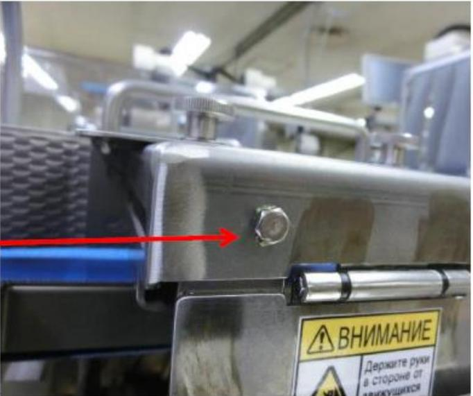
**WPL-AI Inlet Conveyor (Bolt indicated must be on both guides during operation) / Courroie d'entrée WPL-AI (le boulon indiqué doit être sur les deux guides pendant le fonctionnement)**
