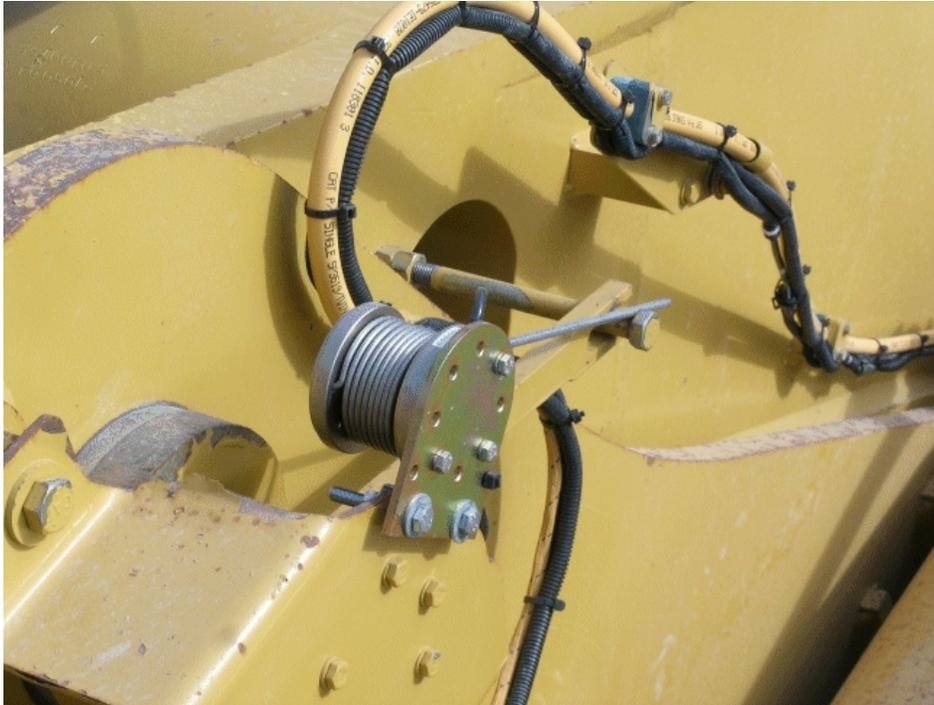
**Typical rotary weighing zone switch / Interrupteur de zone de pesage rotatif typique**
