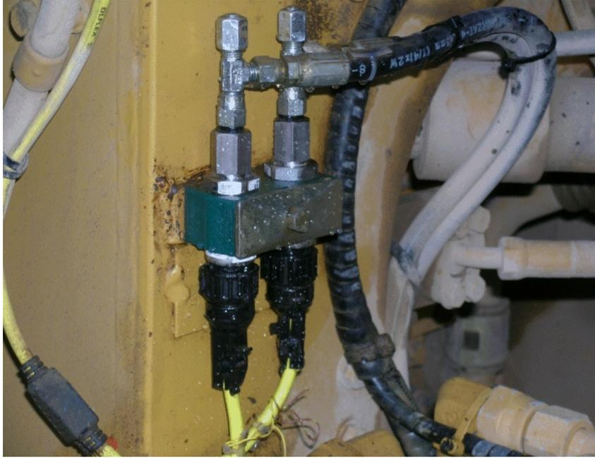
**Typical pressure transducer installation / Installation typique du transducteurs de pression**
