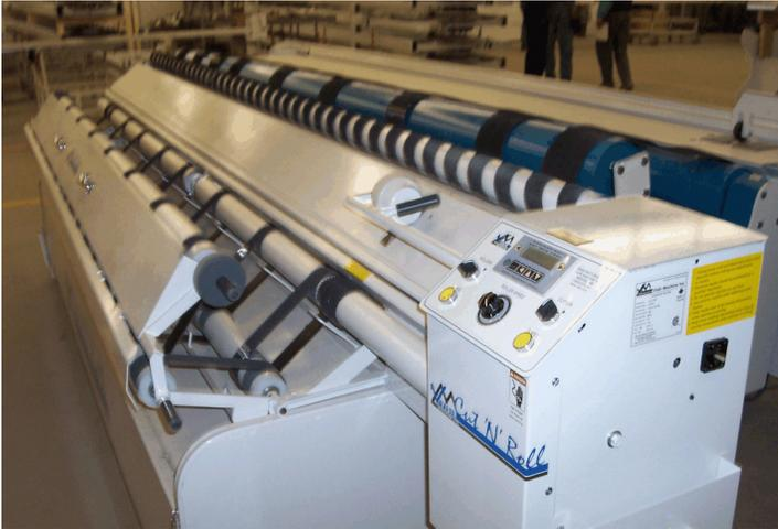
Typical Cut'n Roll Device/Appareil Cut'n Roll typique
