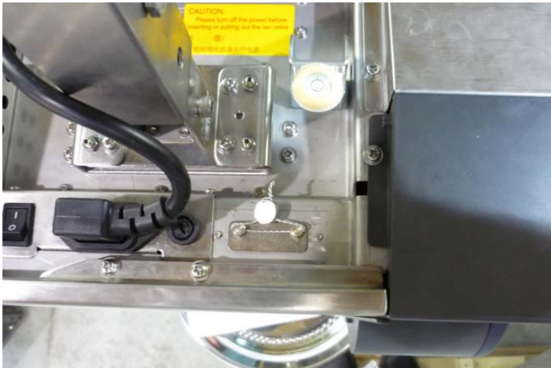
Typical sealing of alternate model SM-100***H / Scellé typique du modèle SM-100***H alternatif
