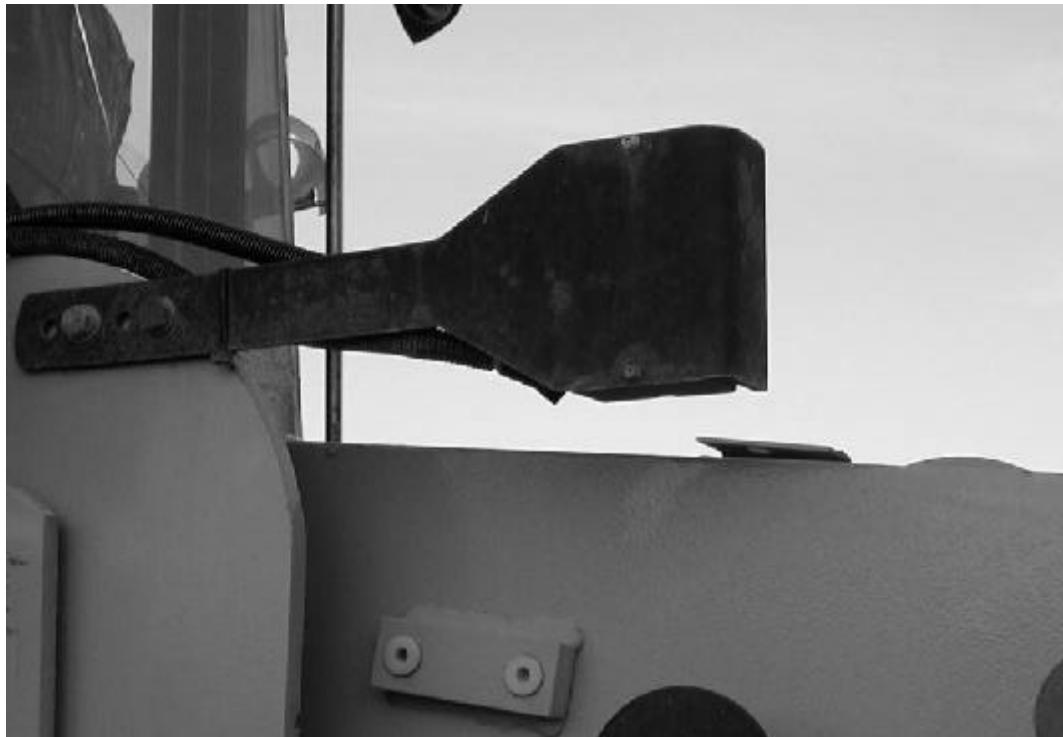
Weighing zone switch / Interrupteur de zone de pesage
