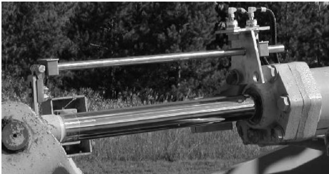
**Open/closed bucket switch / Interrupteur d'ouverture et de fermeture du godet**
