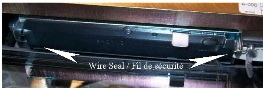
**Model 950\* sealing method / Methode de scellage pour modèle 950\***
