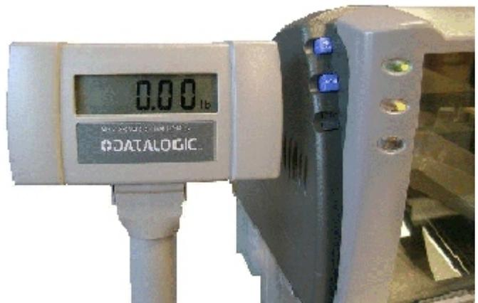
**Typical 960RD remote display and operator controls / Affichage à distance 960RD et touches de contrôle typiques**
