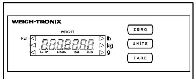
**Model 3734T\* display and keypad / Affichage et cl du modèle 3734T\***
